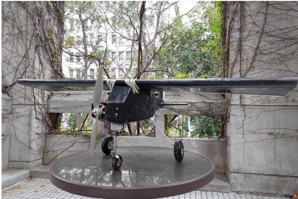
圖 13：自製無人高翼機(碳纖維複材製程)
