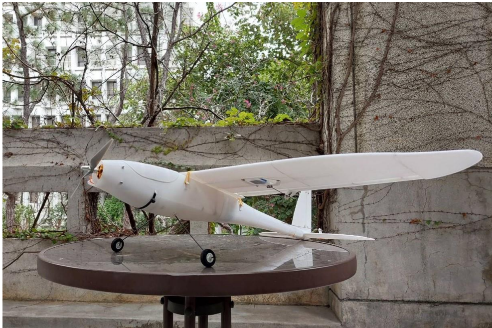
圖 9：自製無人機(3D 列印製程)
