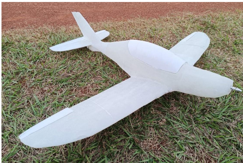
圖 10：自製無人機(玻璃纖維複材製程)
