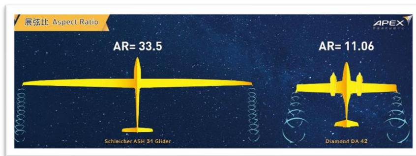
圖 3：提高展弦比可減少誘導阻力(圖源：安捷飛航訓練中心)
