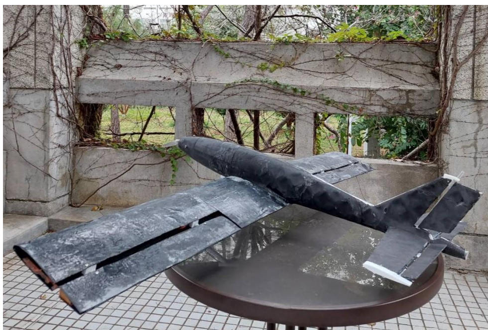
圖 11：自製無人低翼機(碳纖維複材製程)
