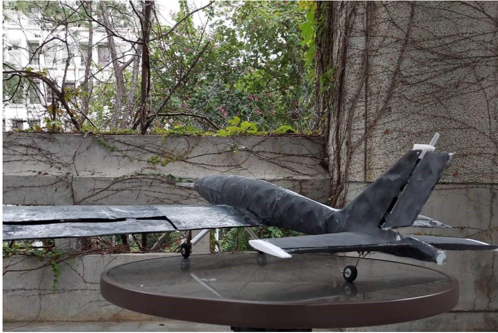
圖 12：自製無人低翼機(碳纖維複材製程)
