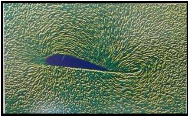
圖 4：翼切型周圍的液體環流-華格納效應(圖源:飛行的奧秘 2006)
