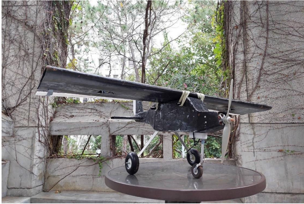
圖 14：自製無人高翼機(碳纖維複材製程)
