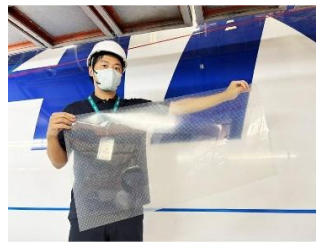
圖(五)，ANA 日本公司所展示的仿生鯊魚皮薄膜。 10
