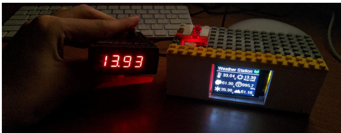
▲圖四：天文用攜帶型天氣站與 Unihedron 公司出的 Sky Quality Meter 進行比較，就 SQM 數值來說，測量結果相當接近，足以勝任夜空光害監測的工作。 (攝影:張家銘/於住家拍攝)
